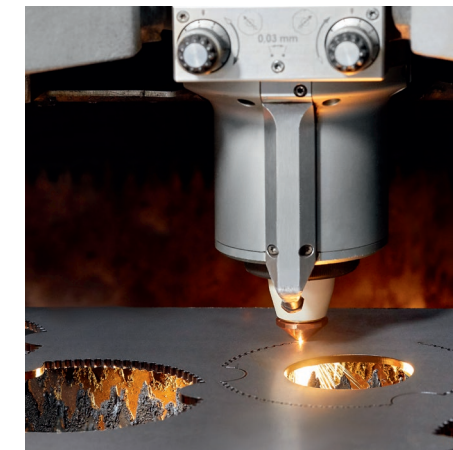
Abb.: Fertigungsverfahren Laserschneiden
